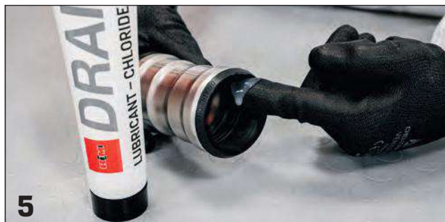
Lubrificazione zona interna guarnizione / Internal gasket lubrication
