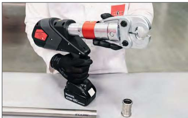
Preparazione della macchina pressatrice / Press machine preparation
