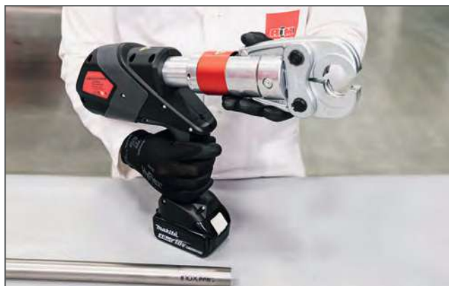
Preparazione della macchina pressatrice / Press machine preparation
